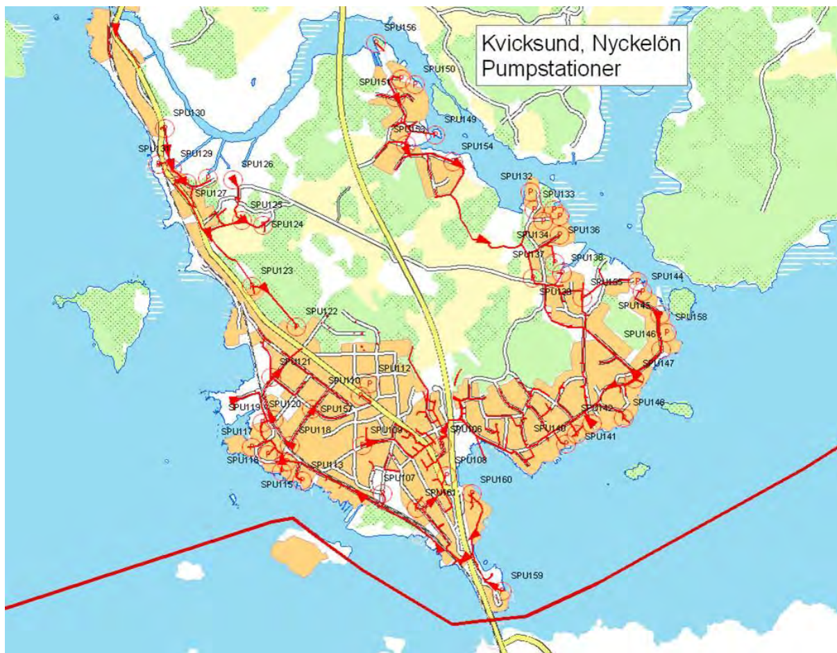
Figur 2. Spillvattennätet på Nyckelön med pumpstationer.
