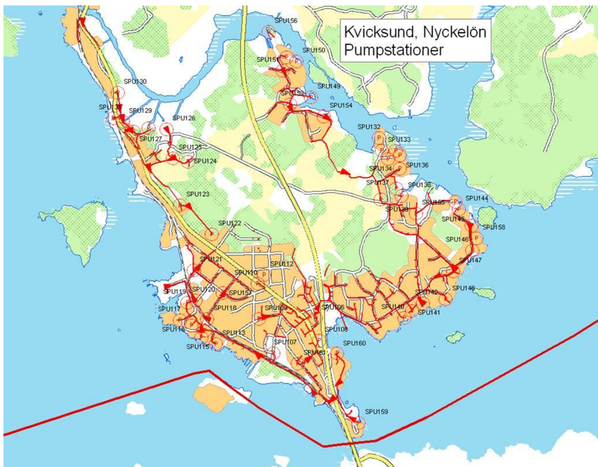
Figur 2. Spillvattennätet på Nyckelön med pumpstationer.
